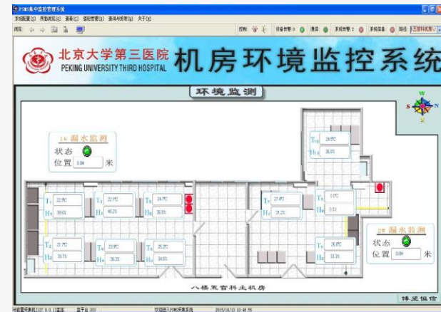
机房环境监控
