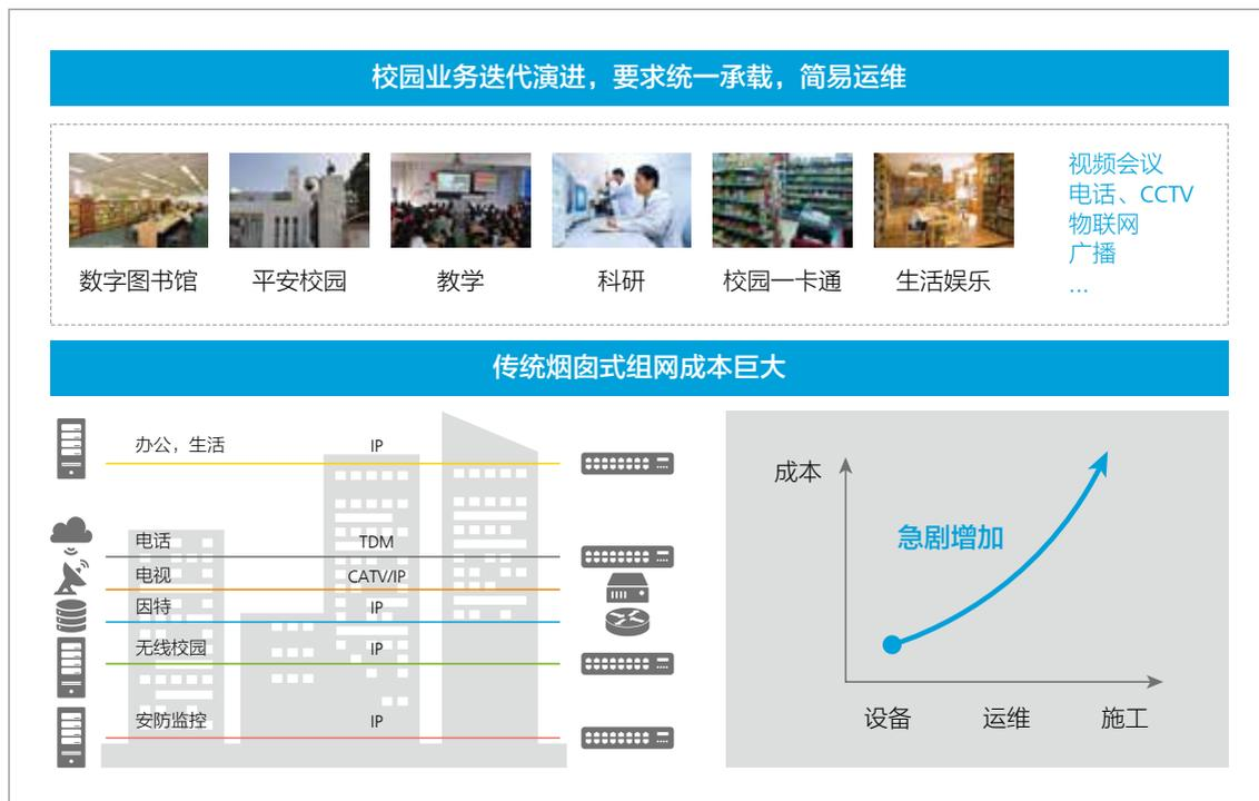
传统校园网为烟囱式组网，监控网，语音网，数据网等独立成网。多级汇聚网络使网络更加复杂，网络维护工作量大，维护难度高。
