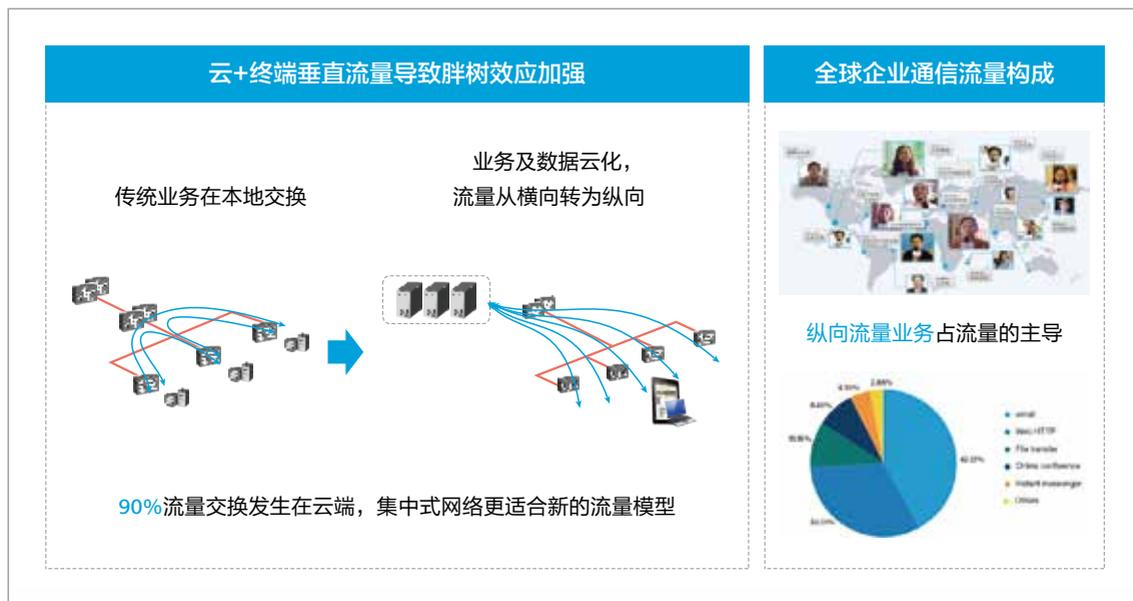
云数据中心及云业务的发展，无形中改变了流量模型，传统园区的业务种类相对单一，而且相当一部分是部署在本地，所以，园区大部分流量在本地横向交换；而云业务的方式，业务向中心汇集，流量也从横向转为纵向，这种变化对网络提出新的要求，比如网络扁平化，低时延，高带宽等。
